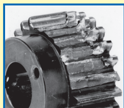
굽힘강도 부족에 의한 파손 예
