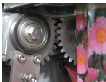
포장기 (NA-4 R-60 K) 의 포장 압착 장치에 세그먼트 형상으로 추가공하여 사용된 SS 평기어
