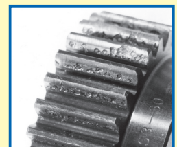
치면강도 부족에 의한 파손 예
