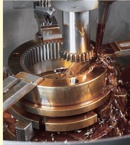
CNC 기어세이퍼에 의한 인터널기어의 치절
