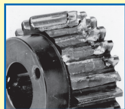
굽힘강도 부족에 의한 파손 예
