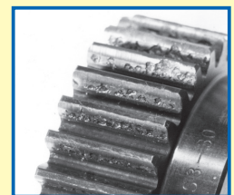
치면강도 부족에 의한 파손 예
