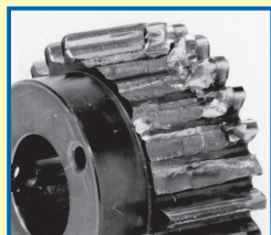
굽힘강도 부족에 의한 파손 예
