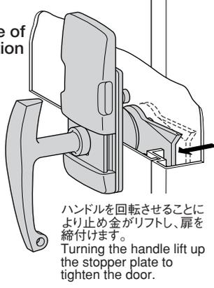
ハンドルを回転させることにより止め金がリフトし、扉を締付けます。
