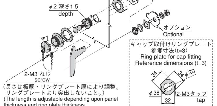
(長さは板厚・リングプレート厚により調整。リングプレートより突出しないこと。)
