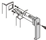
スプリングを外して扉(パネル)を共締めして下さい。
