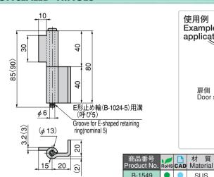
使用例 Example of application 扉側 筐体側 Door side Case side 抜差し型で取付 けが簡単です。 It's slip-joint type so installation is simple.
