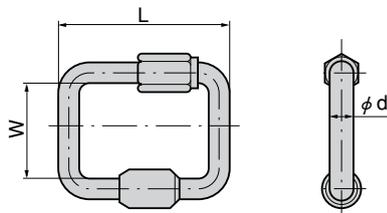
仕様 ●材質：ステンレス鋼棒 (SUS304)
