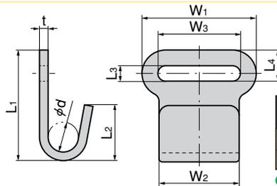
仕様 ●材質：圧延ステンレス鋼板 (SUS420J2)
