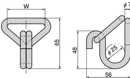
仕様 ●材質：ステンレス鋼棒 (SUS304)
