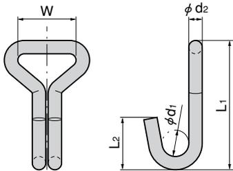
仕様 ●材質：ステンレス鋼棒 (SUS304)
