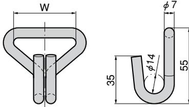
仕様 ●材質：ステンレス鋼棒 (SUS304)
